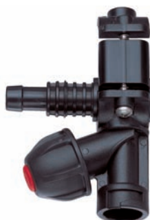
Боковое шланговое соединение для труб с внешн. Ø 3/4" (25-28 мм O.D.) 065.274.56.KL для труб с внешн. Ø 1/2" (20-22 мм O.D.) 065.274.56.KH
